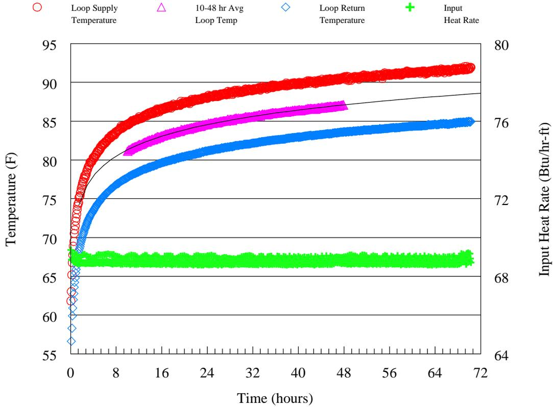
**FIG. 1: TEMPERATURE & HEAT RATE DATA VS TIME**
